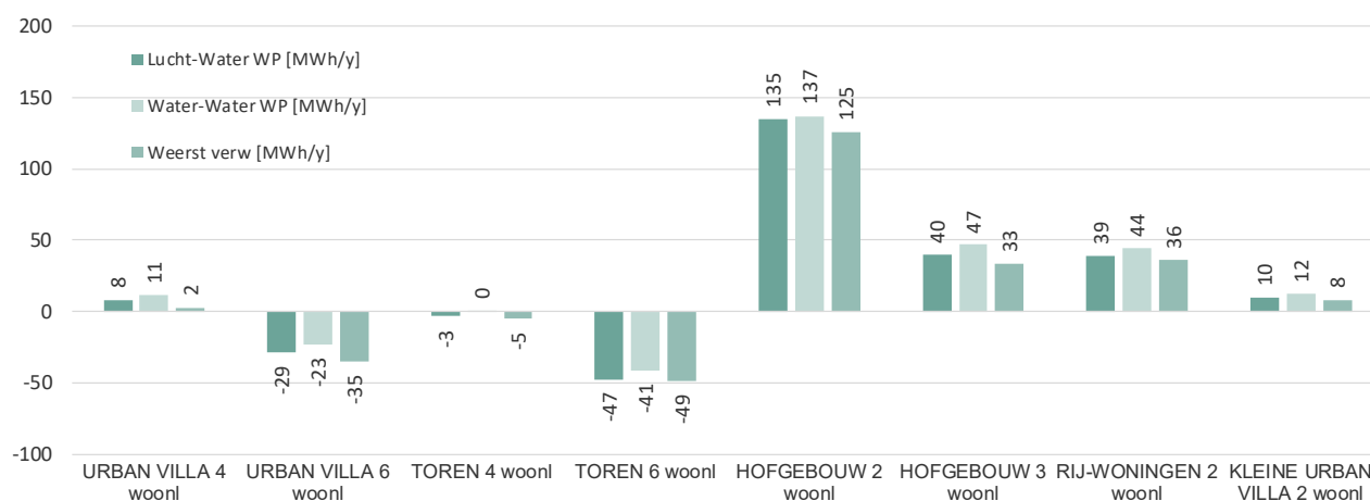
Figuur 7.1: Netto energievraag per bouwtype in MWh/y, inclusief opgewekte stroom uit PV-panelen. Een positief getal wil zeggen een energieoverschot, een negatief getal een energietekort.
