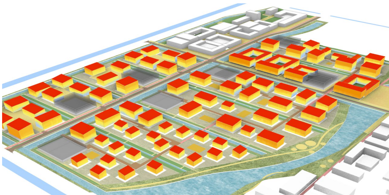
Figuur 11.1: Impressie van de zonintensiteit in de wijk. Deze is berekend met Honeybee 1.1.0 en is toegepast op het 3D model van Posad Maxwan.
