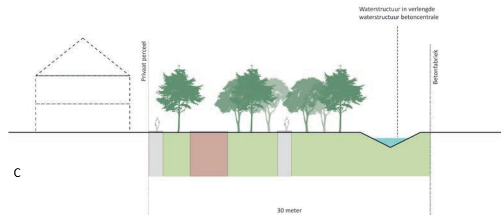
Afbeelding 45: Principeprofiel polderstructuur van 30 meter. Verdere uitwerking is ontwerpogave.
