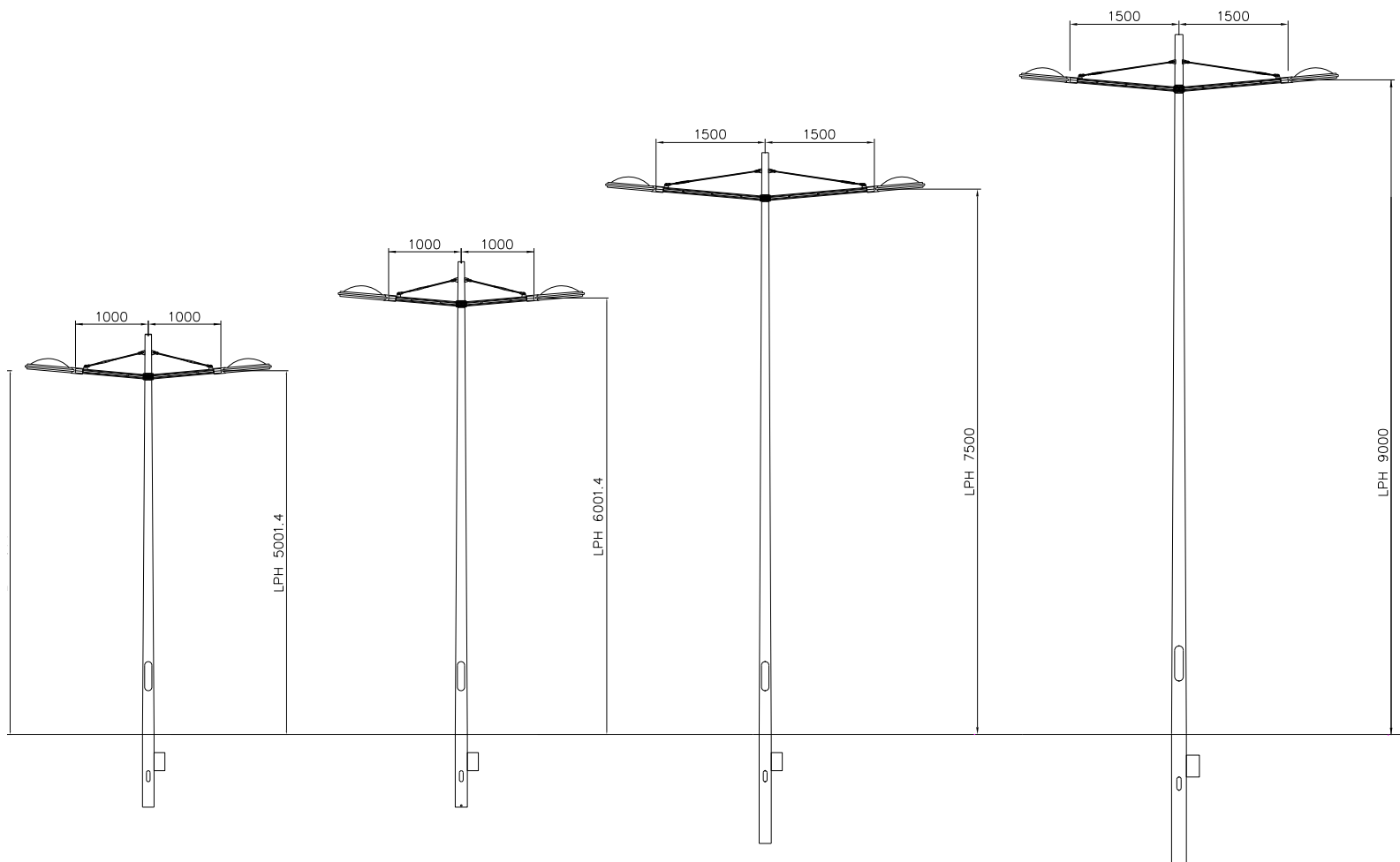
Optie: dubbele uithouder en armatuur
